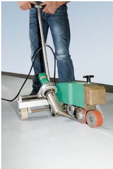
Bild 7. Sichere Nahtfü gung mit Heißluftschweißautomat (Foto: DUD Mitgliedsunternehmen alwitra GmbH & Co.)
